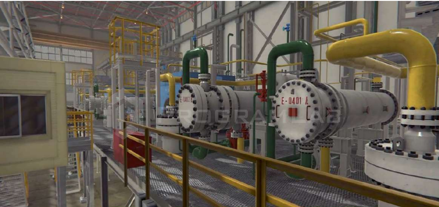
ЦИФРОВАЯ КОПИЯ УЧАСТКА КОМПРИМИРОВАНИЯ ВОДОРОДА
